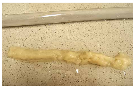
Biofilm aus einer Wasserleitung
